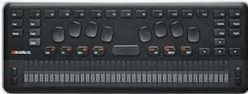
**QBRILLE XL** è un display Braille a 40 caratteri con cursor routing compatibile con gli screenreader più diffusi sia per computer che per dispositivi mobili. Oltre ai comuni tasti di scorrimento accanto alle celle Braille e alla tastiera stile Perkins, nella parte superiore ci sono diversi tasti equivalenti a quelli di una tastiera standard che permettono di gestire il pc senza dover spostare continuamente le mani dal display Braille per utilizzare le combinazioni di tasti.
