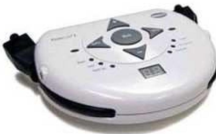
**Powerlink 4** permette di attivare la maggior parte dei dispositivi elettrici (220V) attraverso l'attivazione di un sensore singolo.
