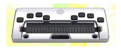
**Luce** è un display braille di **24 caratteri**, piccolo e compatto con tastiera stile Perkins incorporata che permette di prendere appunti velocemente, leggere e scrivere testi, ed effettuare semplici operazioni matematiche.
